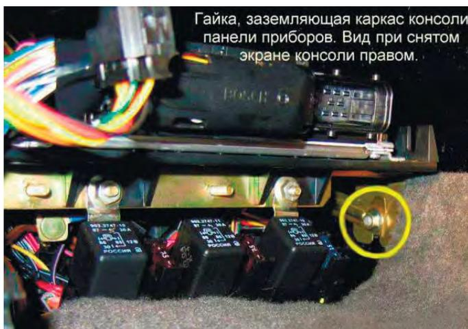
Гайка, заземляющая каркас консоли панели приборов. Вид при снятом экране консоли правом.
