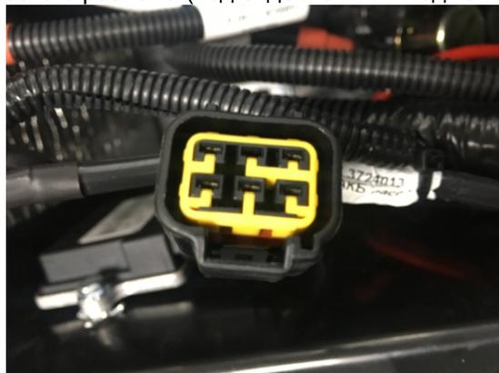
2. Вставить разъём бортового компьютера в диагностический разъём и защёлкнуть его.
