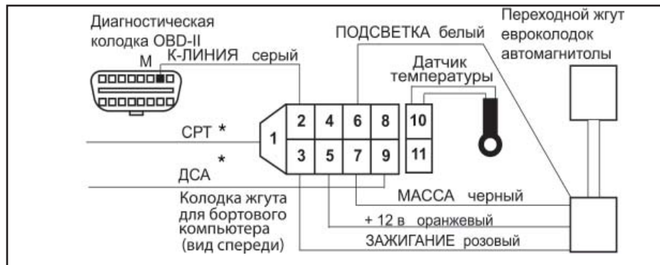
Рис.1. Подключение БК в а/м Aveo, Lacetti, Rezzo.
