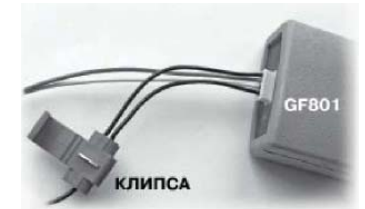
Рис. 6. Подключение парктроника GF 801 для подключения комбинации GF 610 к проводу сигнала расхода топлива
