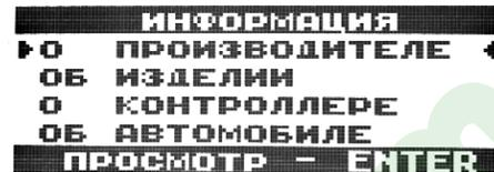
Меню "Информация" включает в себя данные о производителе, изделии, контроллере ЭСУД (тип, версия программного обеспечения) и об автомобиле (сервисные записи контроллера).
