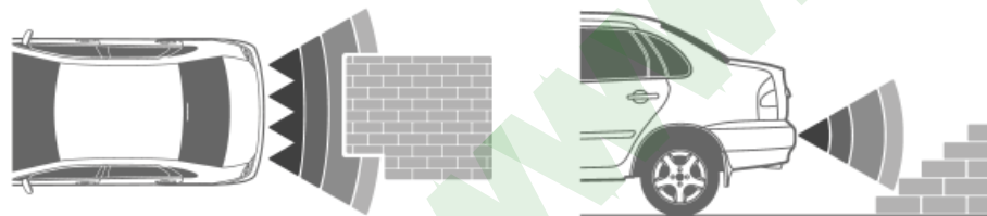
Препятствие сложной формы: сначала парктроник покажет наличие выступа, затем выступ переместится в "слепую" зону.
