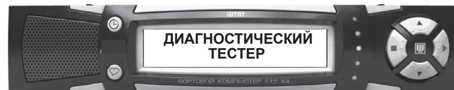
Последовательным нажатием кнопки ■, затем ▲ или ▼ выбрать индикацию группы параметров «ДИАГНОСТИЧЕСКИЙ ТЕСТЕР». Последовательным нажатием кнопки ►, затем ▲ или ▼ выбрать индикацию требуемой функции.
