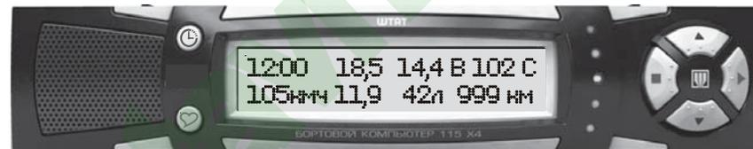
Бортовой компьютер ШТАТ 115 Х42 (далее по тексту БК) предназначен для установки на инжекторные автомобили ВАЗ семейства «Лада-САМАРА», «Лада-САМАРА 2». **Совместим со всеми типами контроллеров BOSCH, Январь, Итэлма (кроме Январь 4.1, GM).** Имеет энергонезависимую память (сохраняет все значения при снятии клеммы с аккумулятора). Возможно обновление ПО через Интернет с сайта [www.shtat.ru](http://www.shtat.ru)
