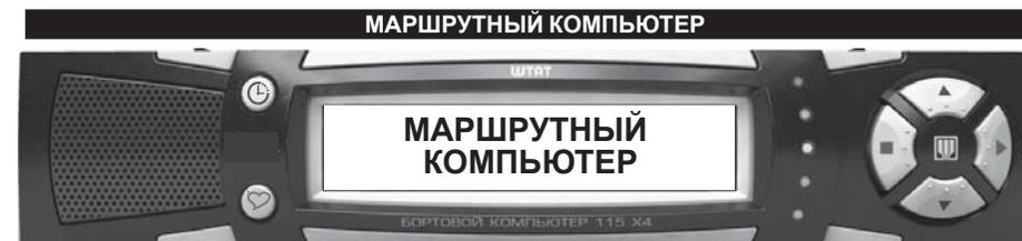
Последовательным нажатием кнопки **■**, затем **▲** или **▼** выбрать индикацию группы параметров «МАРШРУТНЫЙ КОМПЬЮТЕР». Последовательным нажатием кнопки **▶**, затем **▲** или **▼** выбрать индикацию требуемой функции.
