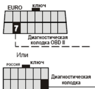
Рис.1. Схема подключения K-линии
