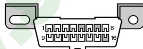
рис.7 Контакты колодки ОБД2
