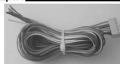
Рис. 2 Жгут для подключения БК
