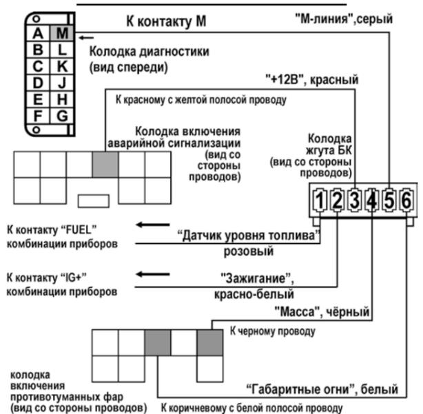
рис.16 Схема подключения к а/м Daewoo Nexia (до 2008 г.в.) (ЕВРО-2), ЗАЗ Ланос Т150 (ЕВРО-2)
