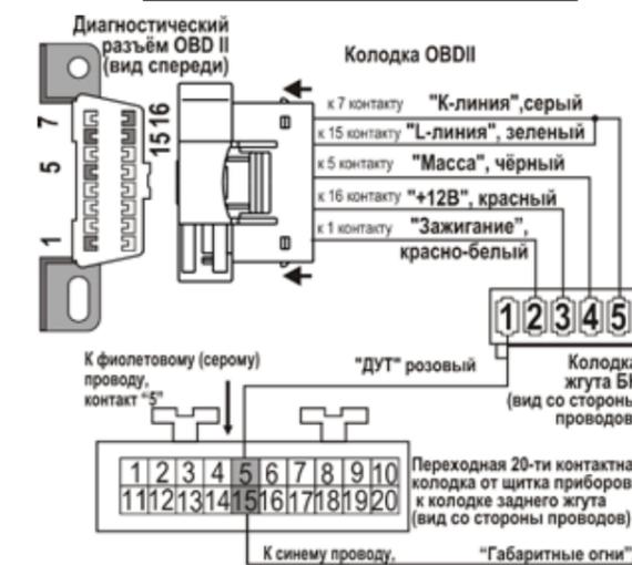
рис.13 Схема подключения к а/м Renault/Dacia Logan серии "Black Line"
