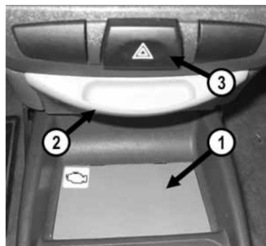
рис.5 Место установки БК
