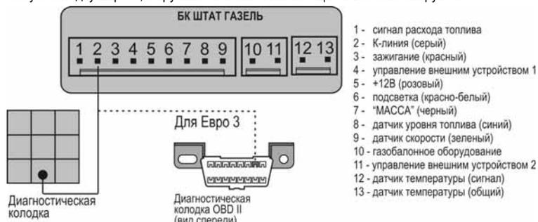
Рис. 5 Схема подключения
