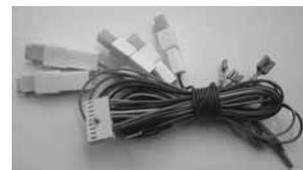
**Рис. 1** Провод для подключения БК
