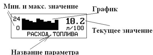
Нажатие на кнопку «Ввод» приводит к переходу на отображения параметра в графической форме, при нажатии на кнопку «Выход» переводит к отображению в цифровой форме.
