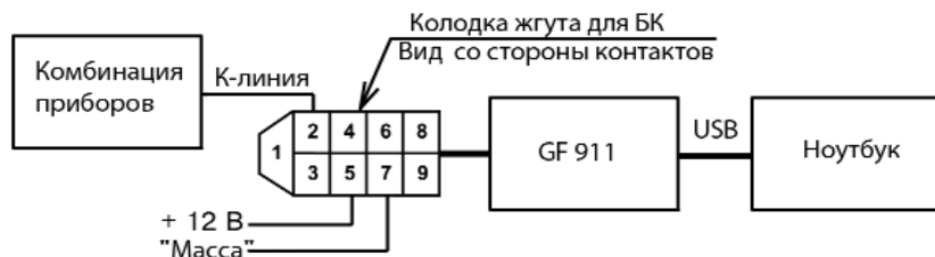
Рис.6. Схема подключений для обновления ПО комбинации приборов GF 607.
