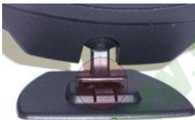
Установка компьютера на платформу
