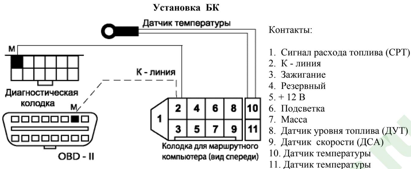
**Рис.1 Подключение БК**
