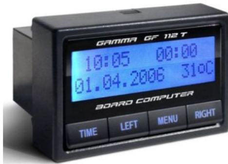
Бортовой компьютер предназначен для установки на инжекторные автомобили ВАЗ семейства 2110. БК совместим с контроллерами BOSCH M1.5.4 / MP7.0 / M7.9.7 / Январь 5.1 / VS 5.1 / Январь 7.2 «Ителма», «Автэл».
