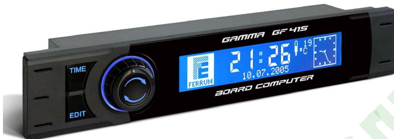
Бортовой компьютер GAMMA GF415 (далее по тексту БК) предназначен для установки на инжекторные автомобили ВАЗ семейства «Лада - Самара», «Лада - Самара - 2».
