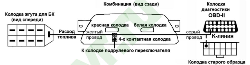
Рис.1. Схема подключения БК комбинации GF613 на автомобилях LADA 2110,2114, 2115.
