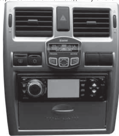
Рис. 12 Вид установленного БК
