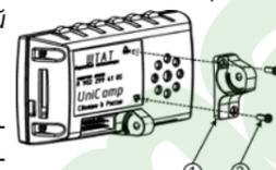
рис.16 Крепление кронштейна к корпусу БК
