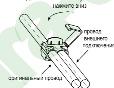
рис.8 Соединение проводов через зажим
