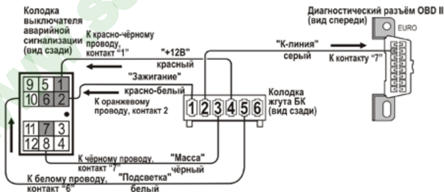
Рис.9 Схема подключения ("КАЛИНА")
